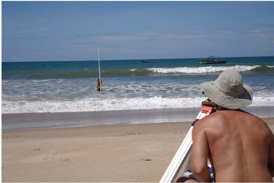
Fig.25. Realização da topobatimetria em um ponto transversal a linha de costa.
