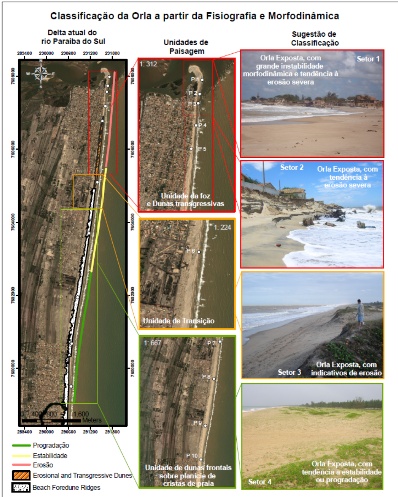
Fig.66: Mapa síntese do comportamento morfodinâmico e respectivas feições associadas, segmentado em unidades de paisagem e respectiva classificação.
