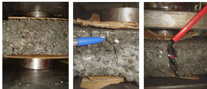
Figura 154: Detalhe da ruptura das peças
