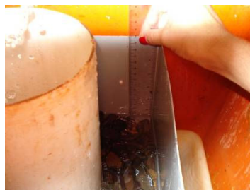
Figura 168: Medição interna para determinar a perda de carga
