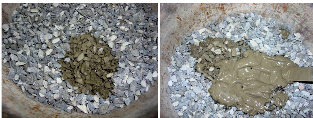
Figura 98: na seqüência, pasta com aditivo e a comparação entre a pasta com e sem aditivo
