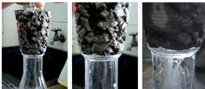
Figura 133: Observação da passagem de água pelo traço 5
