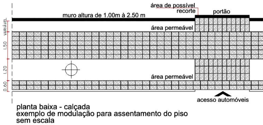
Figura 79: Exemplo de modulação conforme o modelo 1 e 2 da cidade de Maringá Fonte: AUTOR, 2008
