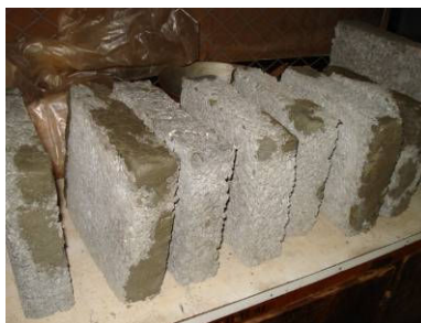
Figura 160: Regularização das peças com argamassa de cimento
