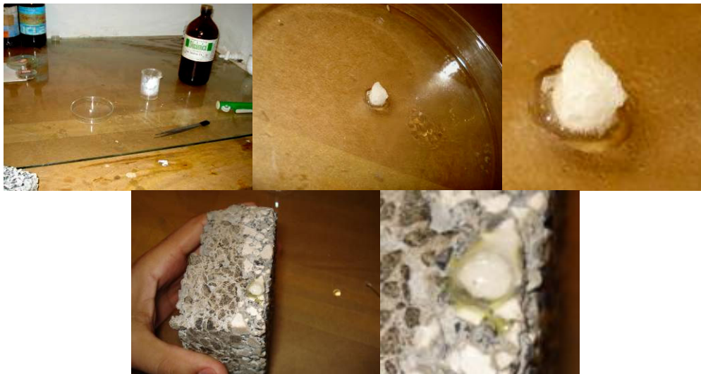
Figura 91: Ensaio com ácido clorídrico, em detalhes os pedriscos de calcário com a reação ao ácido clorídrico
