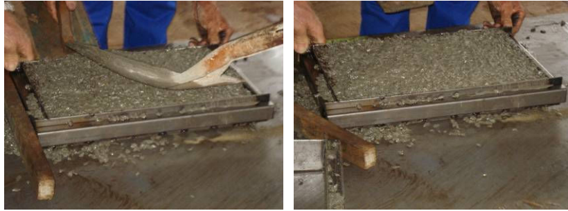
Figura 143: Preenchimento da fôrma e adensamento com a mesa vibratória
