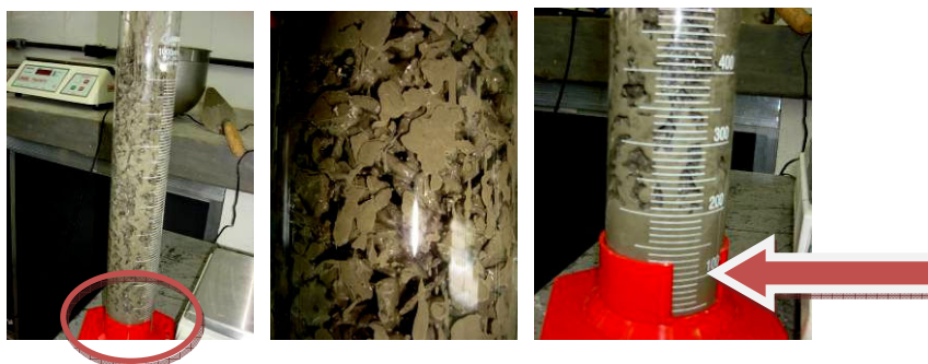
Figura 104: Mistura da pasta do traço A, com aditivo e com acúmulo no fundo da proveta. Fonte: AUTOR, 2008
