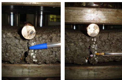
Figura 158: Ruptura do corpo-de-prova
