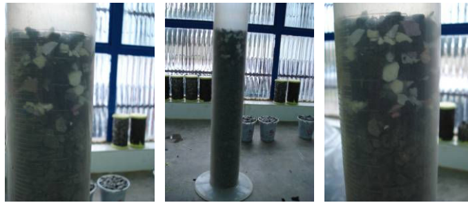
Figura 134: forma como foi mensurado o volume dos agregados, superior Britaleve® e inferior o pedrisco
