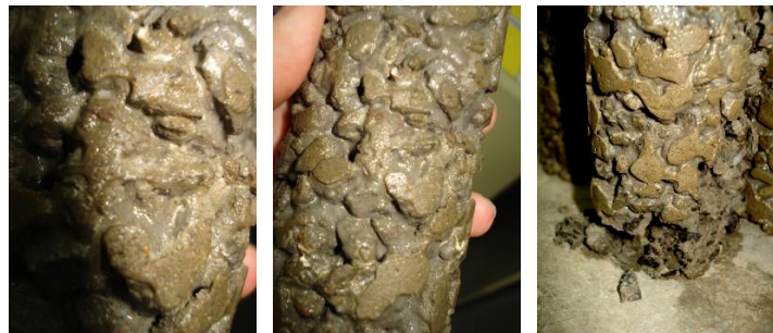
Figura 136: Corpos-de-prova após o rompimento, traços 4.1, 4.2, 4.3.
