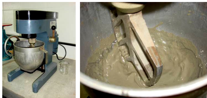
Figura 100: Misturados mecânico utilizado para misturar a pasta de cimento
