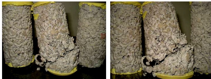
Figura 118: Corpos-de-prova dos traços 5,6 e 7 depois de rompidos
