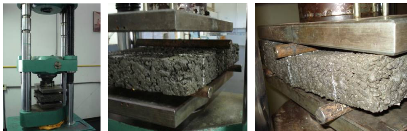
Figura 157: Corpo-de-prova na prensa, posicionamento das barras de ferro e ruptura.
