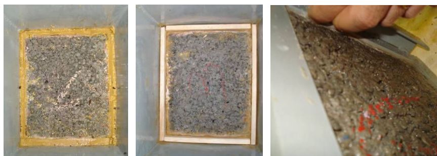
Figura 164: Vedação das laterais entre a amostra e a caixa com bentonita e massa de vidraceiro
