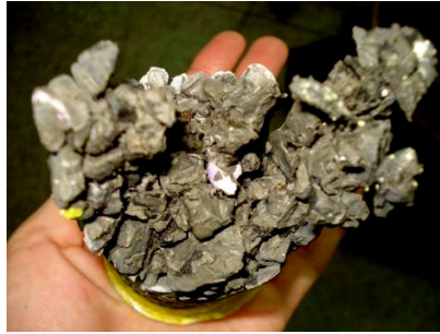
Figura 112: Detalhe do corpo-de-prova do traço 3 rompido
