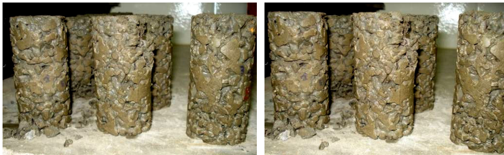
Figura 135: Corpos-de-prova depois de rompidos, traços 4.1, 4.2, 4.3, 5.1, 5.2 e 5.3.
