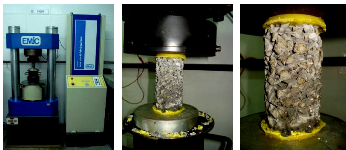
Figura 109: Corpo-de-prova 50 x 100 mm, traço 1, colocado na prensa
