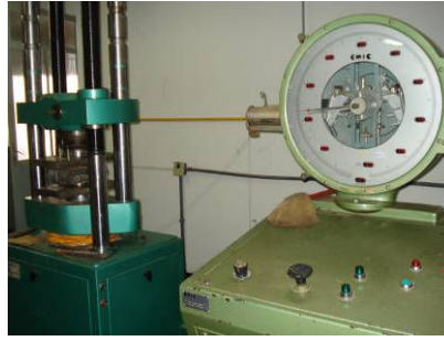
Figura 152: Prensa utilizada para a realização do teste de resistência à compressão
