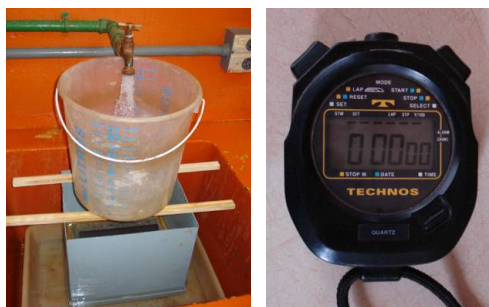
Figura 169: Instrumento de medição da vazão de entrada do ensaio
