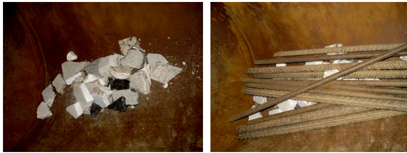
Figura 94: Material colocado no interior do moinho de barras, e material com a carga de abrasiva, respectivamente.
