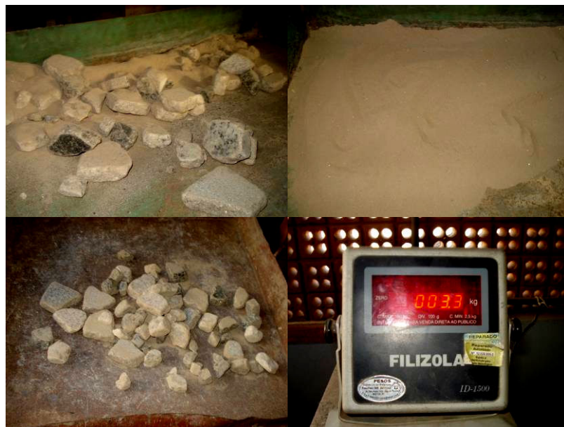
Figura 95: Material resultante do moinho: resto das placas com pó, separação do pó, separação das placas e resultado da pesagem das placas separadas do pó, respectivamente.
