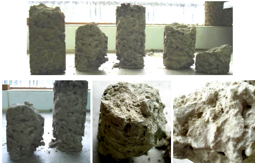
Figura 120: Imagem dos corpos-de-prova esfarelando, vista de todos e em detalhe
