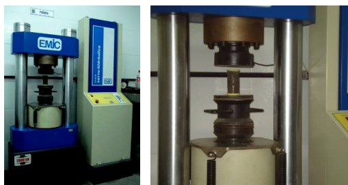
Figura 130: Vista do corpo-de-prova na prensa
