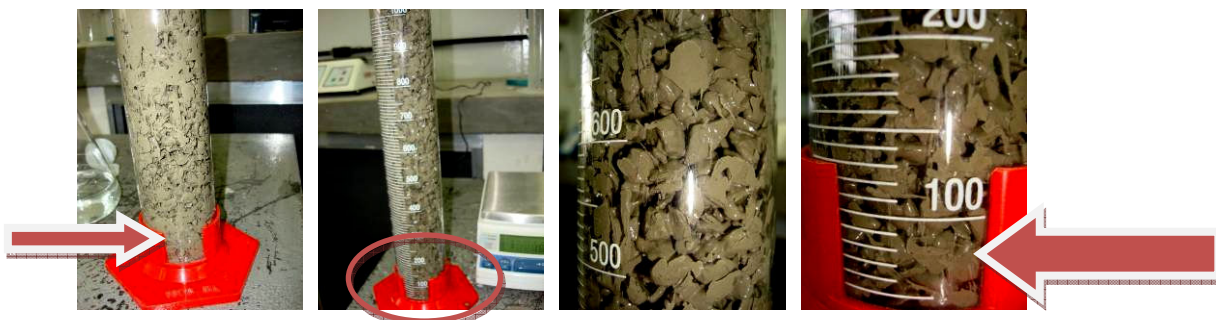
Figura 102: Mistura da pasta sem aditivo (traço B), e verificação do não acúmulo de pasta no fundo da proveta. Fonte: AUTOR, 2008
