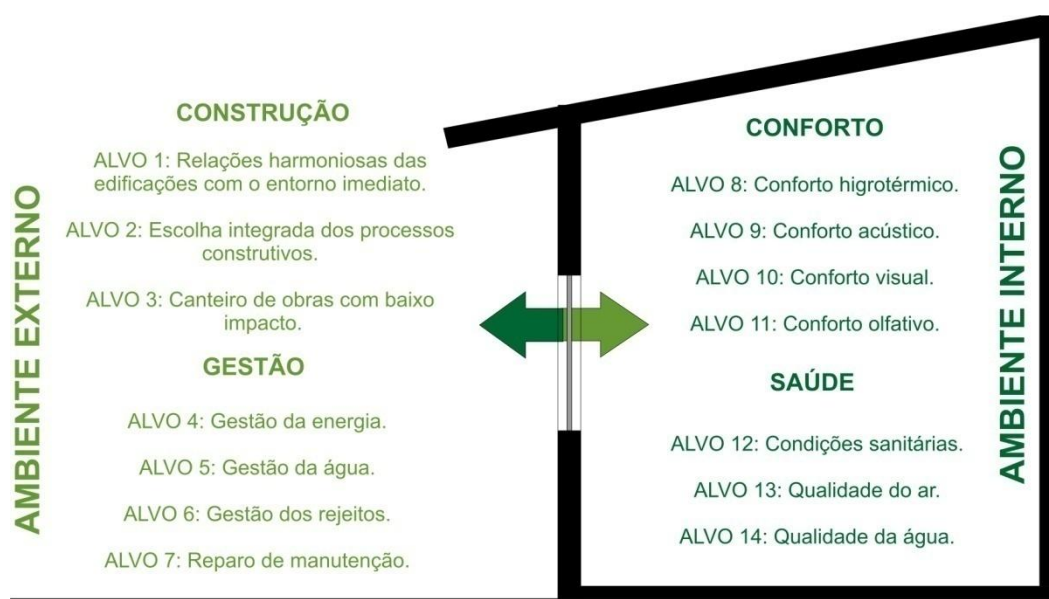
Figura 22 – Esquema de organização dos 14 alvos ambientais nas 4 principais instâncias referentes ao exterior e interior da edificação (Fonte: Adaptado de WEKA apud BARROSO-KRAUSE, 2005).
