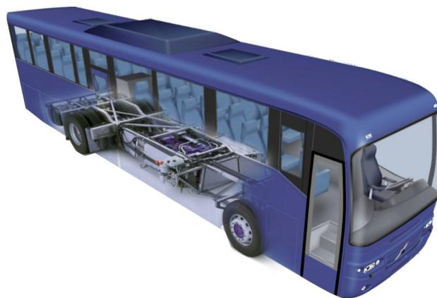
**Figura 1 – Carroceria montada sobre um chassi de ônibus rodoviário**
