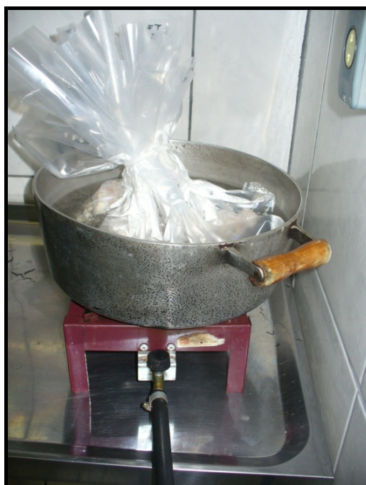
Figura 7: Cocção das amostras em água fervente para realização dos testes de maciez e perda de peso por cozimento.
