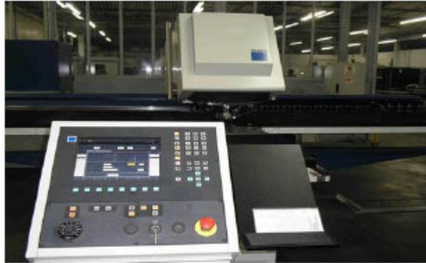
Figura 1. Máquina puncioneira CNC utilizada na produção
