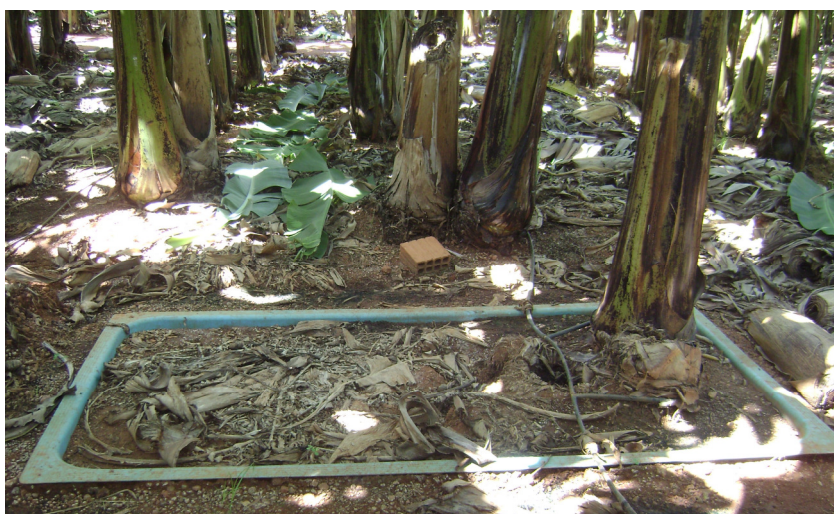
Figura 5. Lisímetro de drenagem uma caixa de fibra de vidro com capacidade de 3.000 litros situado no lado direito da área experimental (Ld 2 )
