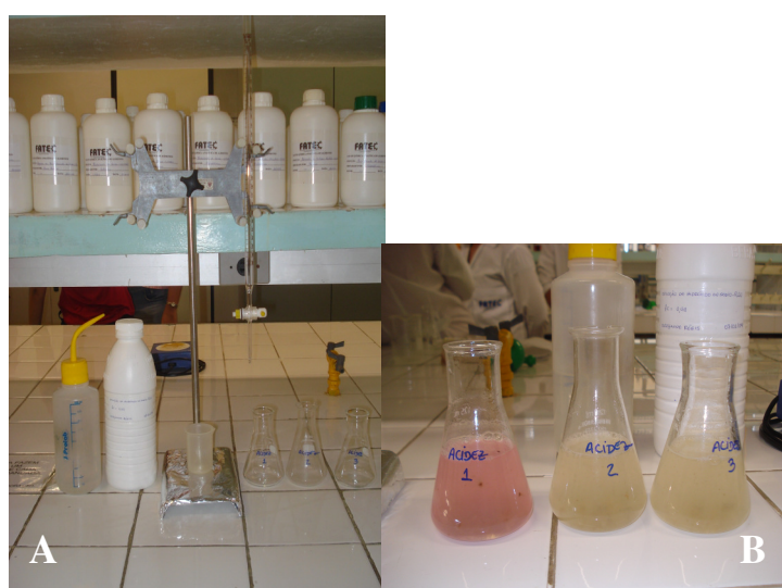
Figura 21. Vidrarias usadas e solução para titular (A) e depois de feita a titulação até a obtenção da coloração rósea no fruto de bananeira cv. Pacovan Apodi (B)
