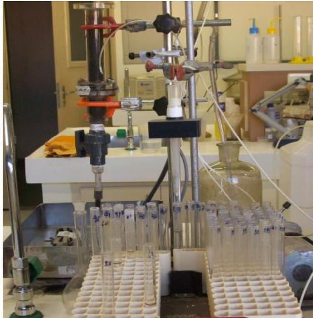
**FIGURA 4.2** – Esquema utilizado em laboratório para os ensaios em colunas.
