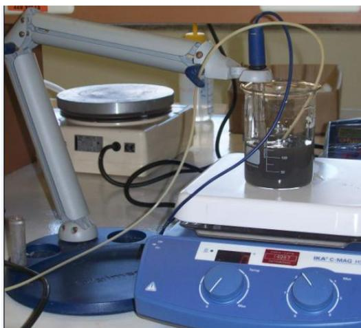
FIGURA 4.1 – Esquema utilizado em laboratório para remoção de manganês através de ensaios em batelada.
