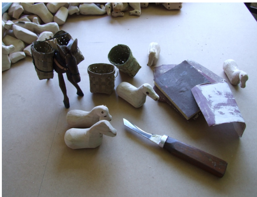
Figura 36 – Utensílios (faca e lixa) para confecção e pré-formas das mulas artesanais. (Foto: Artur Barcelos, 2009).
