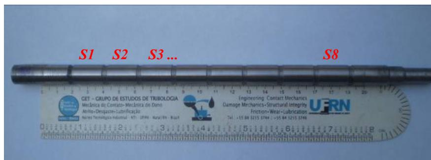
**Figura 27** – Haste metálica subdividida em oito seções cilíndricas.
