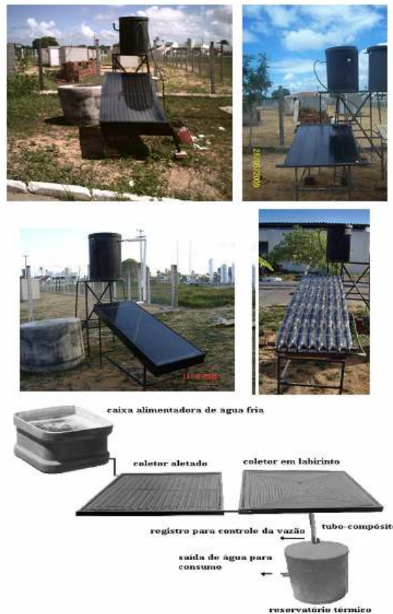
Figura 2.2. Sistemas de aquecimento solares de água estudados no LMHES/UFRN.
