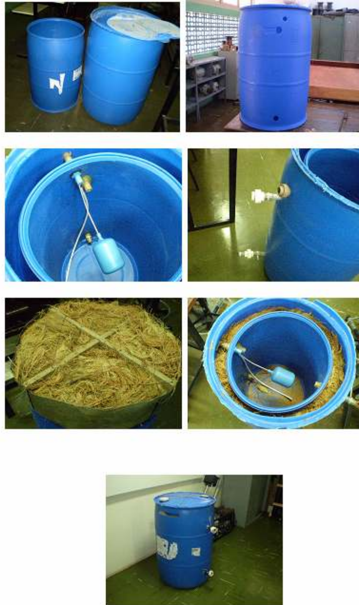
Figura 3.8. Etapas da fabricação e montagem do RTA100.
