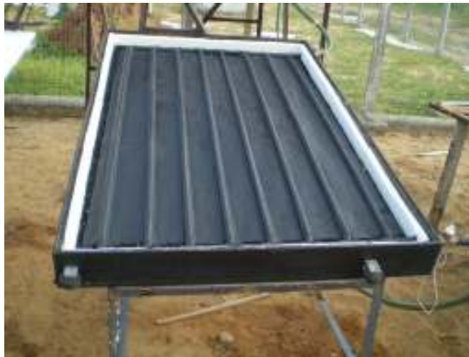
Figura 3.6. Colocação da grade absorvedora na caixa do coletor.
