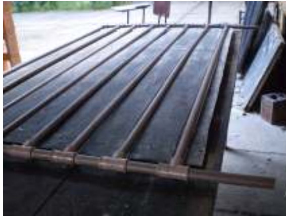
Figura 3.2. Formação da grade absorvedora.
