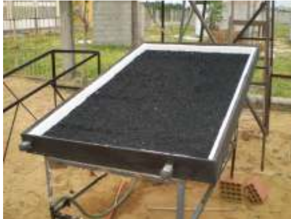
Figura 3.5. Colocação do isolante térmico no fundo da caixa do coletor.
