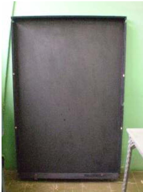
Figura 3.4. Montagem da caixa do coletor.
