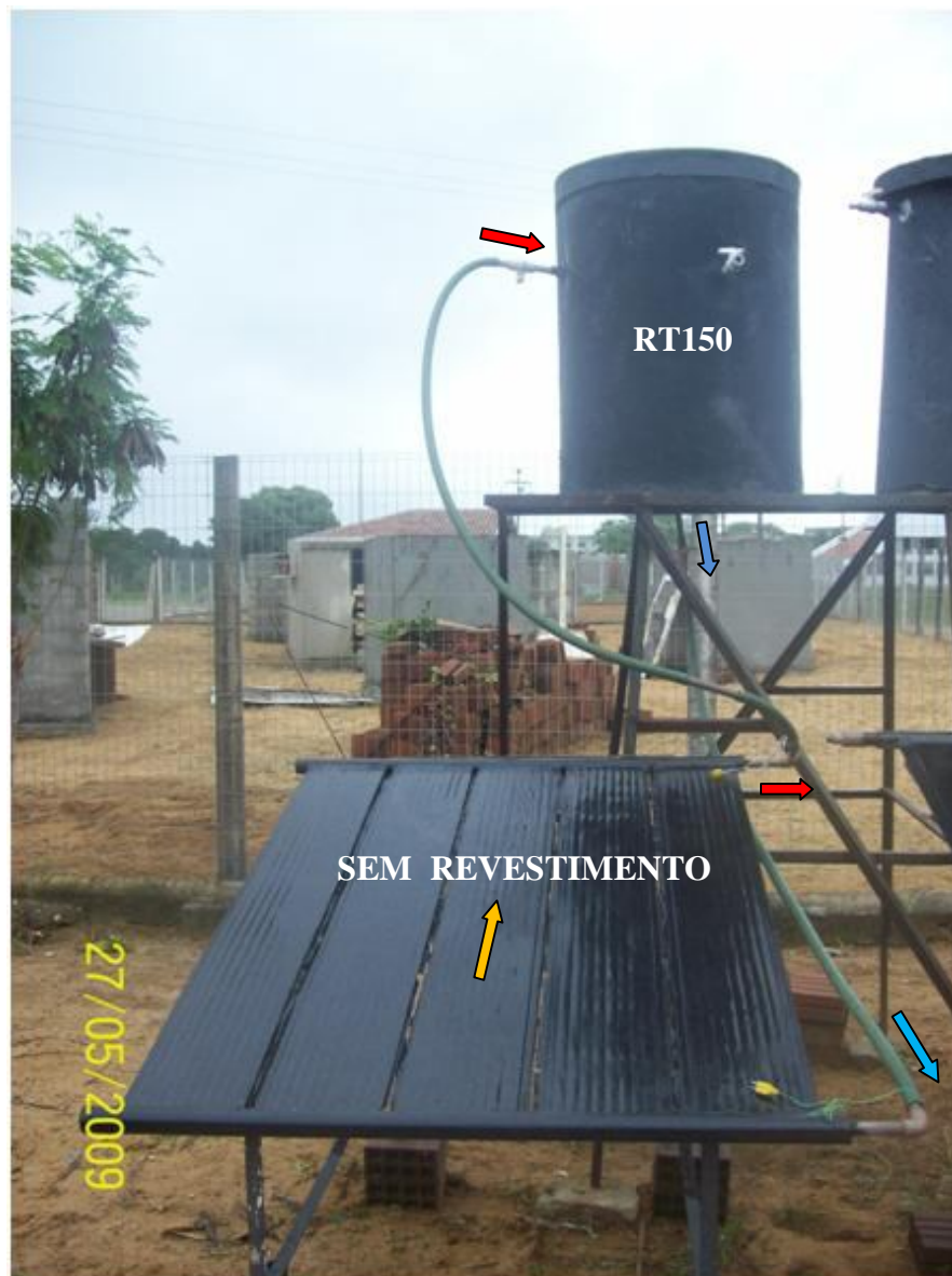
FIGURA 2.22. Sistema de aquecimento solar sem revestimento metálico (CONFIGURAÇÃO I).
