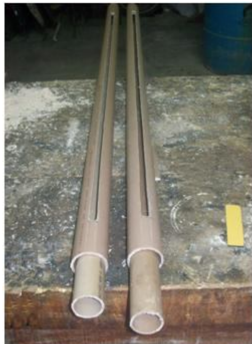
FIGURA 3.7. Tubo de Ø32 mm já no interior do tubo de Ø40 mm.
