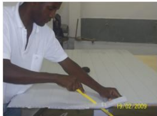
FIGURA 3.5. Corte das placas de PVC.
