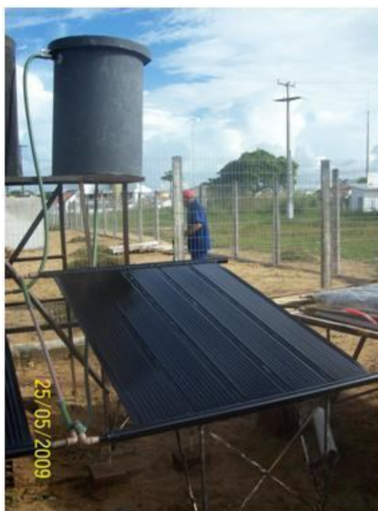
Figura 3.1. Modelo do sistema coletor alternativo proposto.
