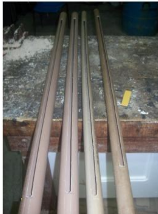
Figura 3.3. Tubos de distribuição ( \varnothing 40 mm e \varnothing 32 mm) com os rasgos concluídos.
