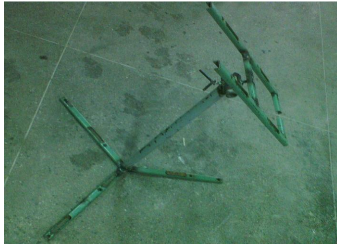
Figura 3.6. Estrutura do heliostato.
