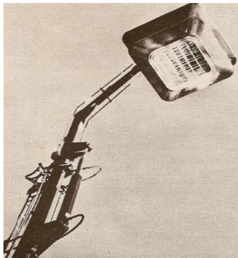
Figura 2.4. Modelo de cavidade desenvolvida pela Ansaldo, na Itália, para a central européia EURELIOS (Foto Ansaldo-1 979).
