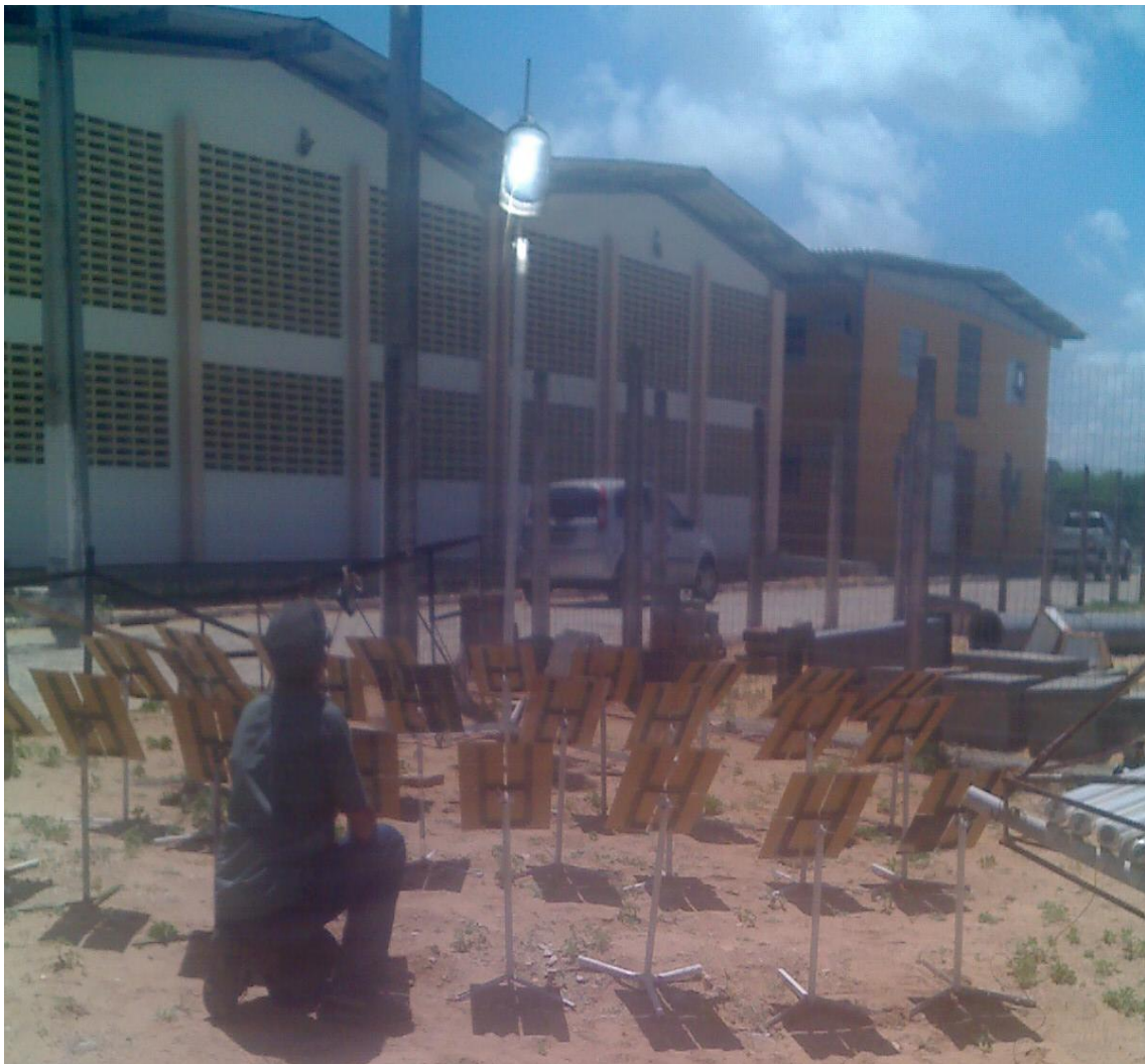
Figura 3.17. Modelo central torre solar em teste.
