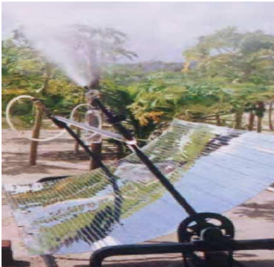
Figura 2.21. Concentrador cilindro-parabólico em operação.
