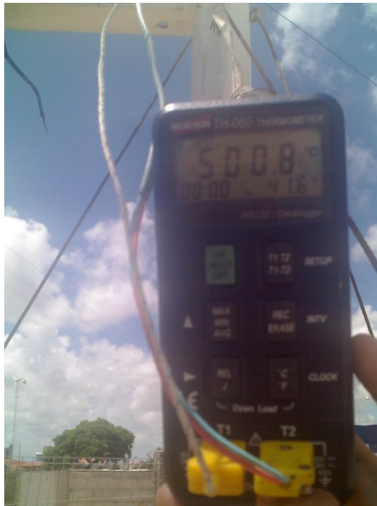
Figura 3.16. Máxima temperatura coletada para o absorvedor sem carga.
