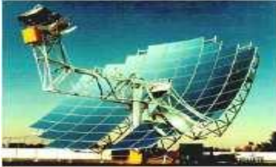
Figura 2.16. Protótipo Dish-Stirling nos EUA.
