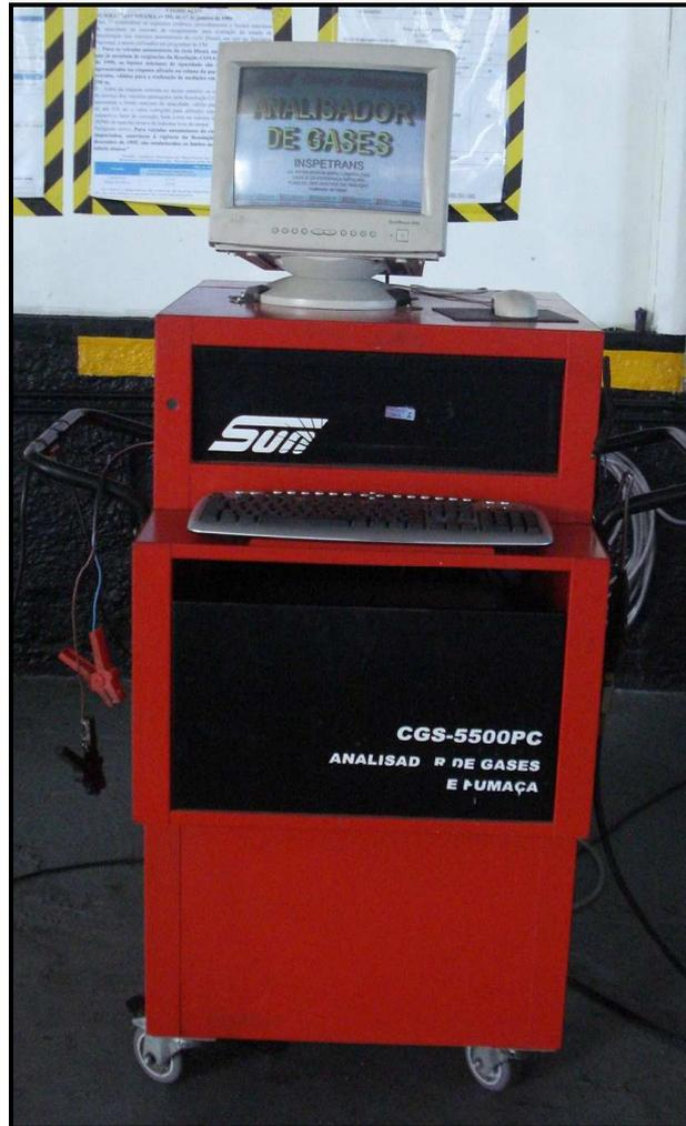
**Figura 49: Analisador de gases CGS-5500PC**
