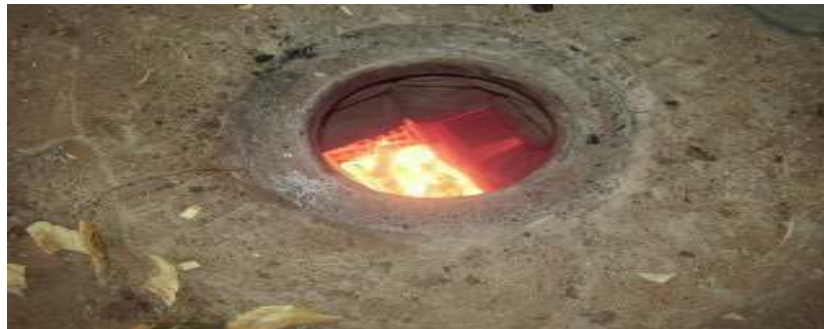
Figura 14: Vista superior – alimentador durante a sinterização
