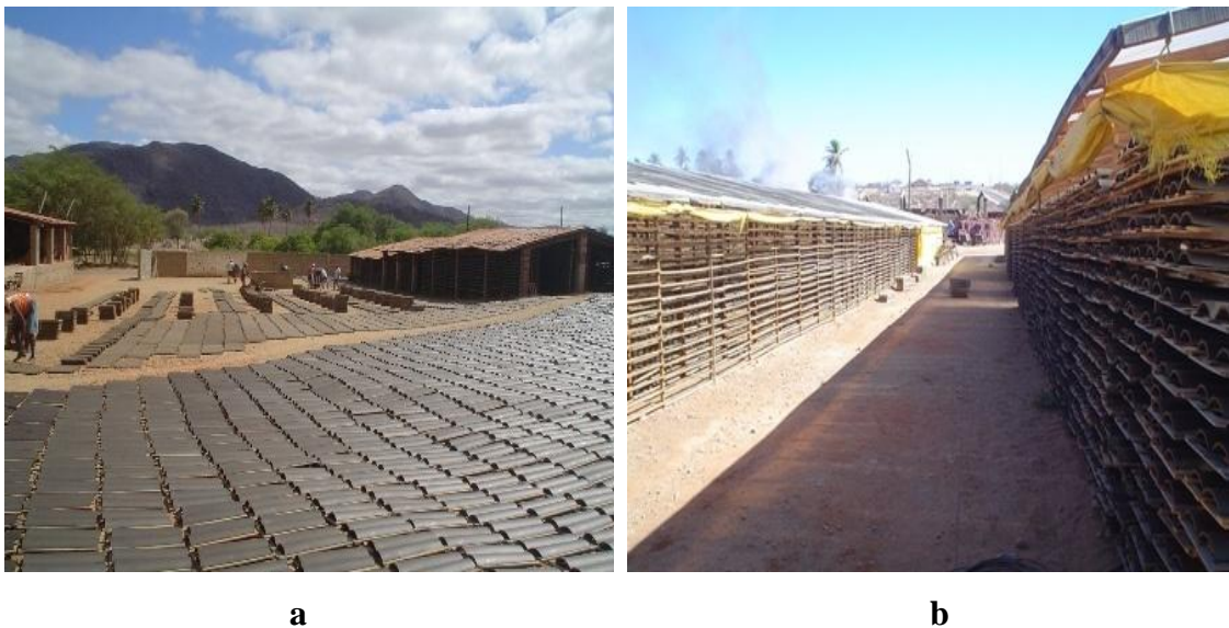
Figura 4.9. Processo de secagem (a) no pátio e (b) nos galpões.
