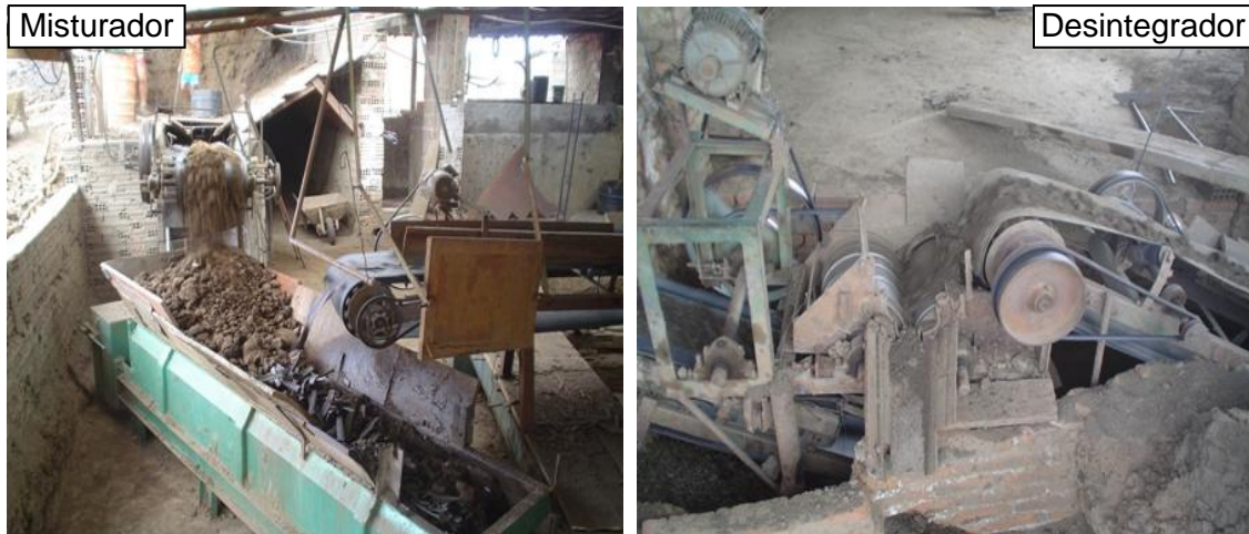
Figura 4.6. Equipamentos usados na preparação da massa pré-conformação.
