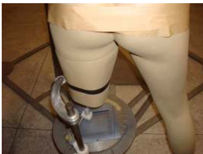
Figura 35: posicionamento do braço marcador no manequim
