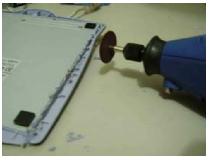
Figura 30: corte do gabinete do Pen Tablet
