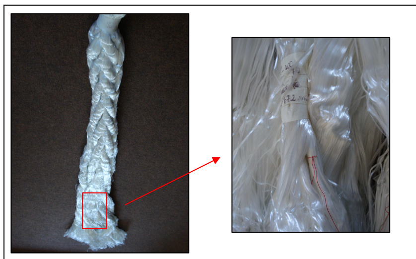
Figura 3.3 – Alma de poliéster. (a) Alma de Poliéster cedida pelo POLICAB. (b) Contagem de multifilamentos existentes em uma perna.
