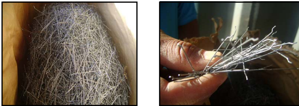
Figura 3.3 – Fibras metálicas adicionadas ao concreto
