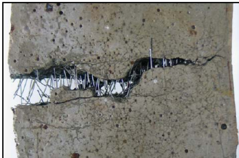
Figura 4.4 – Rompimento por tração direta de corpos de prova de concreto reforçado com fibras metálicas (FORMAGINI et al., 2006, p.6)
