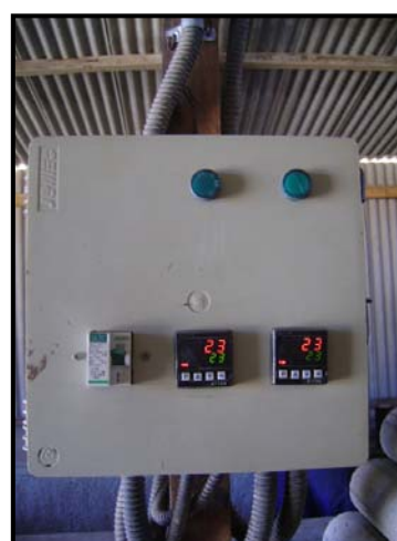
Figura 2.2 – Sistema de cura dos corpos de prova de concreto com controle automático de temperatura
