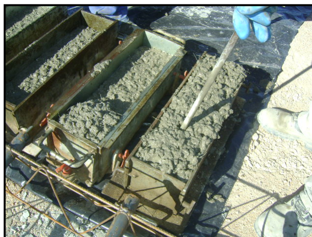
Figura 3.4 – Moldagem de corpos de prova prismáticos de concreto
