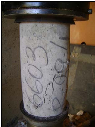
Figura 2.3 – Fratura no corpo de prova do concreto no momento do rompimento
