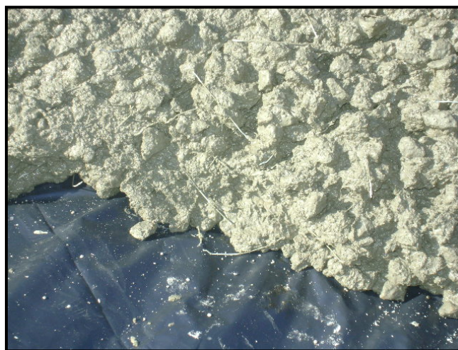
Figura 4.2 – Concreto com adição de fibras
