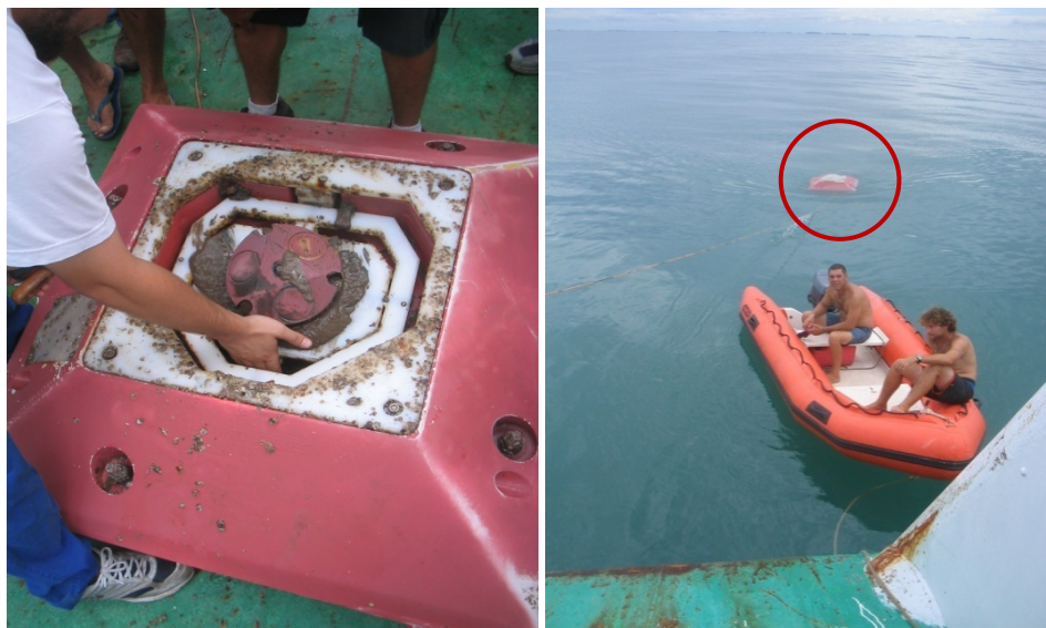
Figura 4 - A direita detalhe da recuperação do fundeio com bote inflável e, ao fundo (em destaque), a parte flutuante do sistema de proteção que contém o ADP. Na foto à esquerda, detalhe do ADP e das incrustações nesta parte do sistema de proteção contra redes de arrasto.
