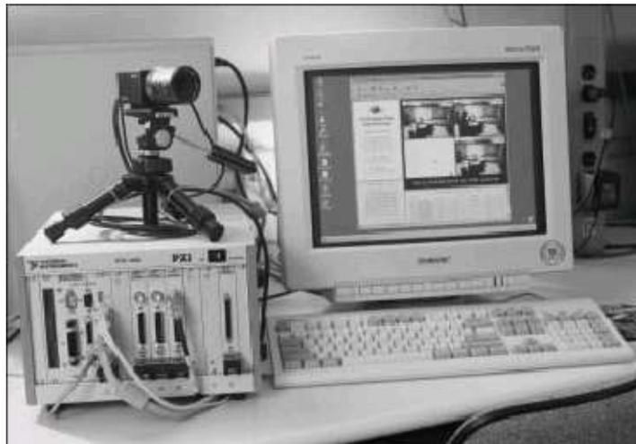
**FIGURA 5.12 – EQUIPAMENTO PARA AQUISIÇÃO DE IMAGENS BASEADO EM ARQUITETURA PXI. (Cortesia: Los Alamos National Laboratory)**
