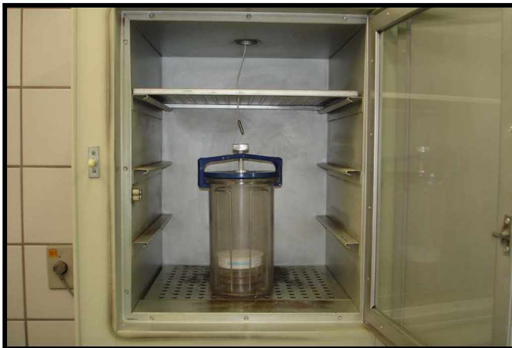
Foto 8 – Jarra de Anaerobiose GasPak (Permutation) contendo placas inoculadas, ativadas pelo gerador de gás carbônico Anaerobac® com fita indicadora
