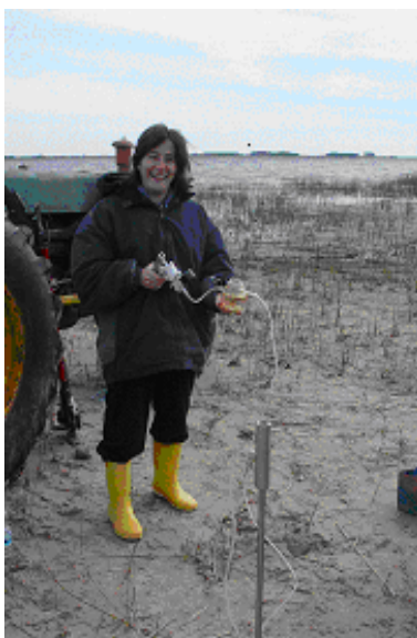
FIGURA 3.5 – Coleta e filtração de amostra em poço piezométrico.
