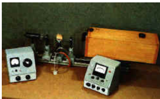
FIGURA 1.1 – Protótipo do AA1 apresentado por Walsh, 1955
