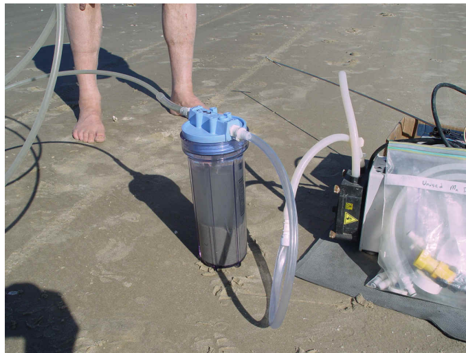
FIGURA 3.7 – Sistema de sucção e filtração de amostra
