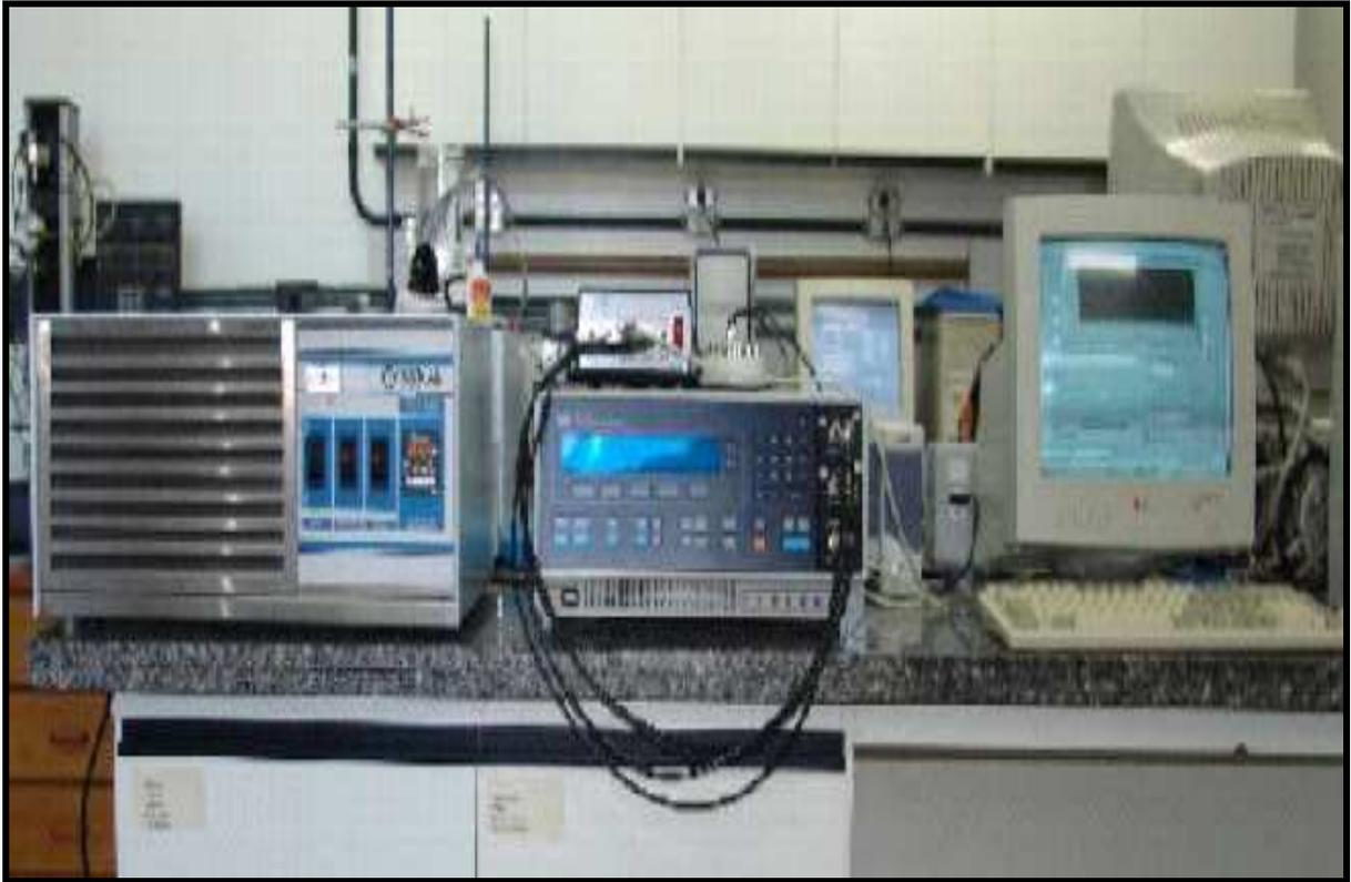
**Figura 18** – Sistema completo da “língua eletrônica” mostrando sequencialmente da esquerda para a direita o banho termostatizador, o medidor de impedância e o computador
