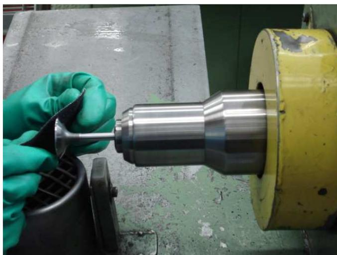
**Figura 03:** Operação de lixamento da face da válvula.
