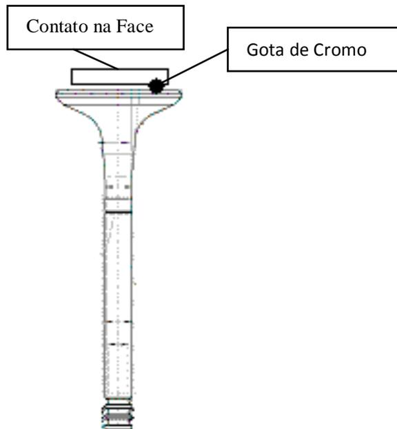
**Figura 32:** Desenho esquemático do teste realizado em laboratório para a coleta de dados para a análise de regressão da Resistência Elétrica da peça versus a temperatura da peça.
