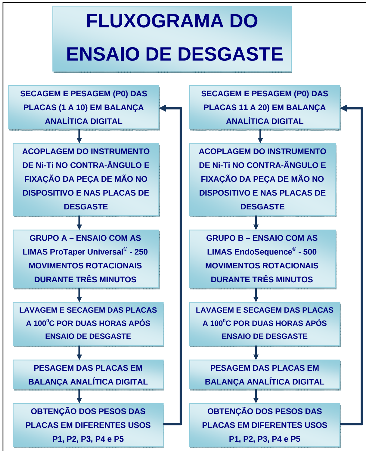
Figura 9 – Fluxograma do ensaio de desgaste
