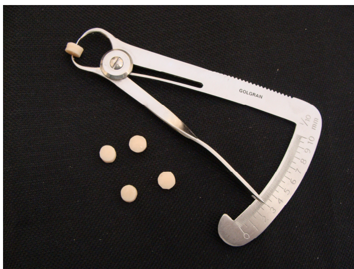
Figura 12 - Corpos-de-prova para o teste de microdureza e MEV
