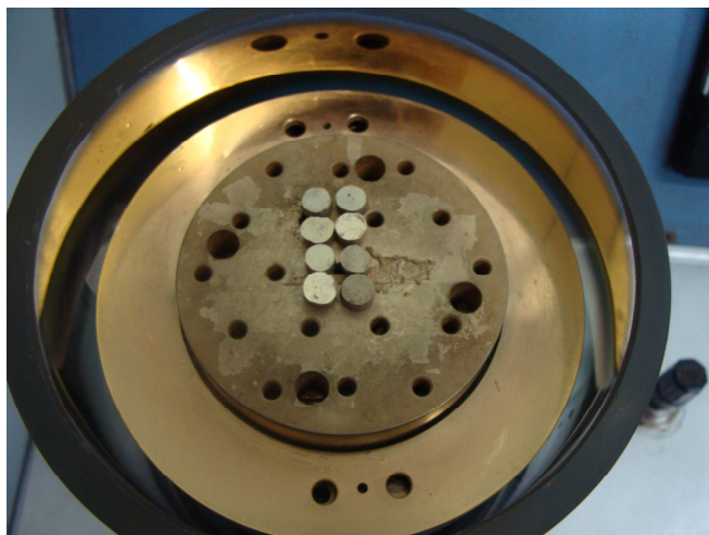
Figura 24 – Corpos-de-prova após a deposição de ouro
