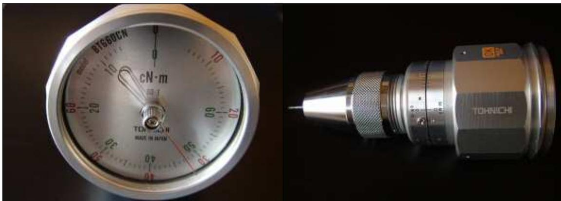
Figura 13 - Torquímetro analógico
