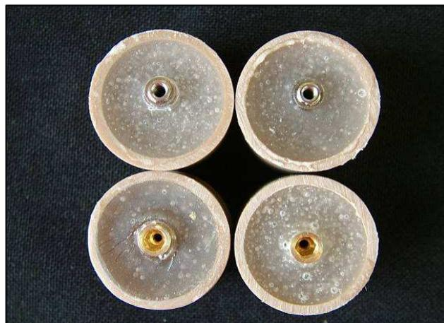
Figura 5 - Corpos-de-prova após a polimerização final da resina
