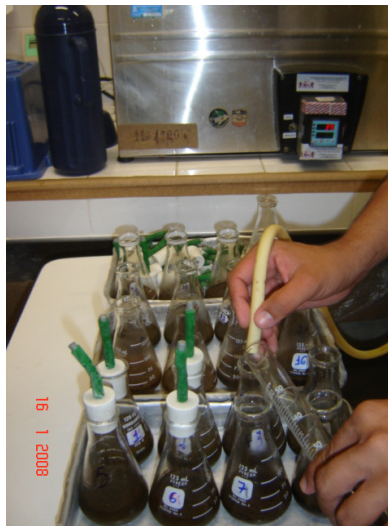
Figura 8. Borbulhamento com CO 2 para incubação das amostras
