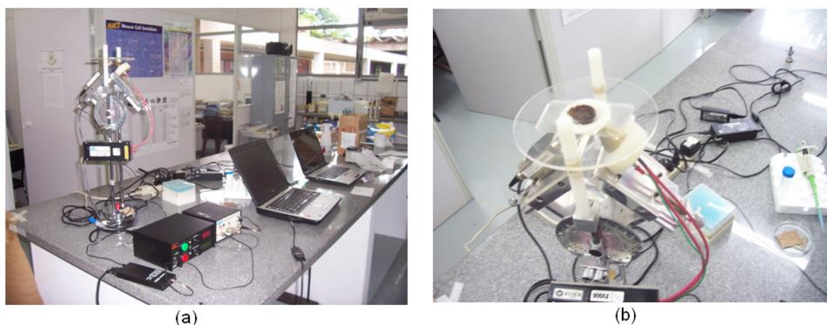
Figura 11. Sistema portátil de excitação e detecção por PXRF (LFNA-02) vista geral em (a) e detalhe da medida in natura em (b)
