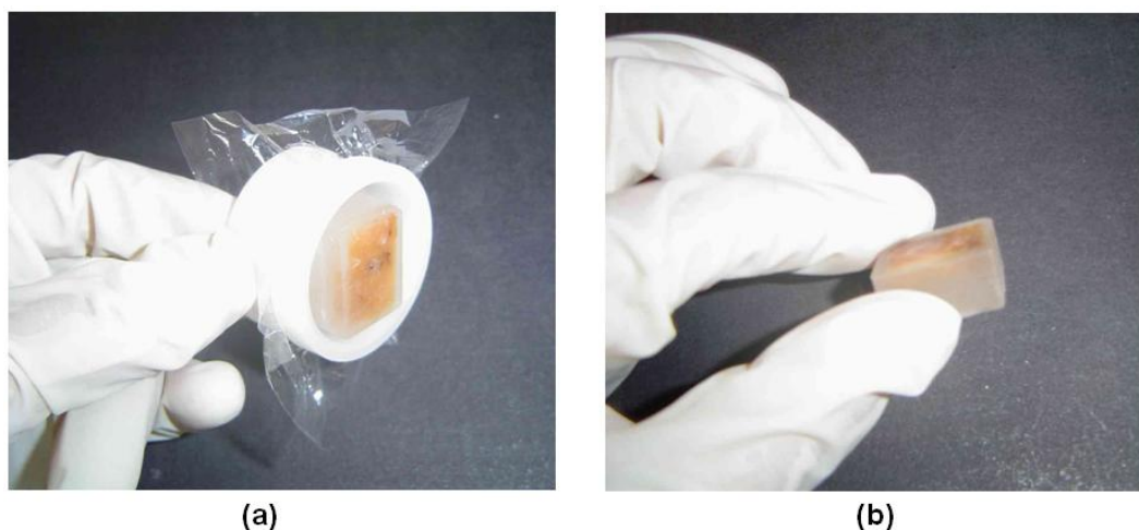
Figura 28. Em (a) a amostra padronizada no porta amostra, em (b) detalhe da padronização da amostra antes dos cortes com micrótomo.
