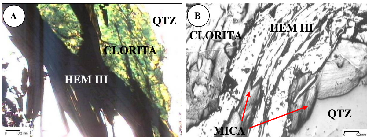
FIGURA 16 - Fotomicrografias da Hematita III (especularita) associada à mica e a clorita (A) sob a luz transmitida polarizada; (B) luz refletida. Amostra FSP01-PROF.231,15m.
