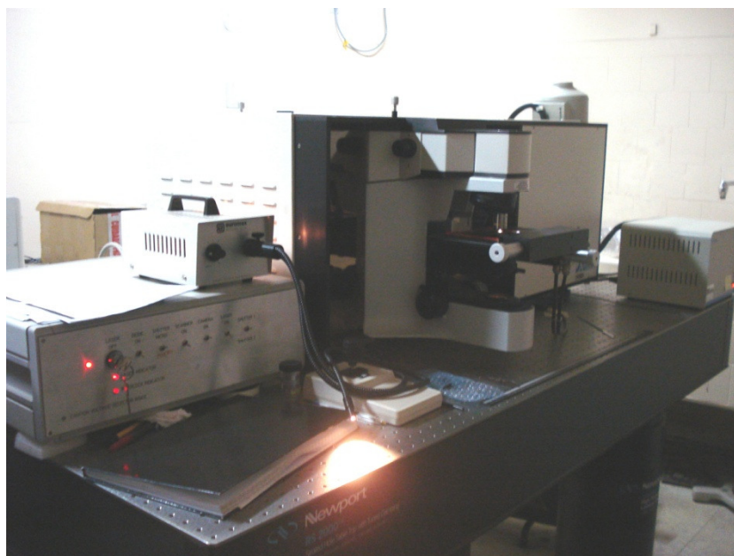
FIGURA 59 - Fotografia do equipamento de espectroscopia micro Raman utilizado.
