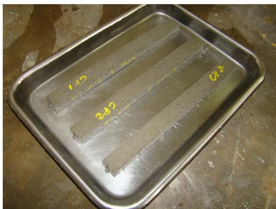
Figura 34 – Barras de argamassa em solução de NaOH
