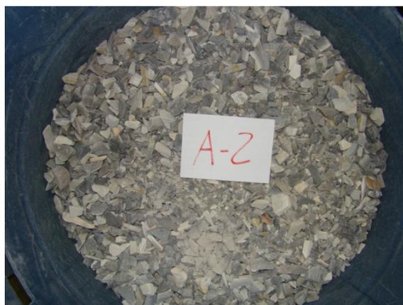
Figura 39 – Agregado graúdo de quartzito CAP3
