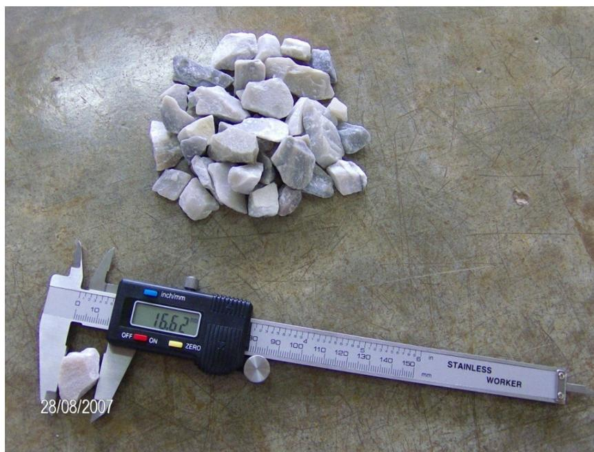
Figura 27 – Paquímetro utilizado nas medições do ensaio de índice de forma.
