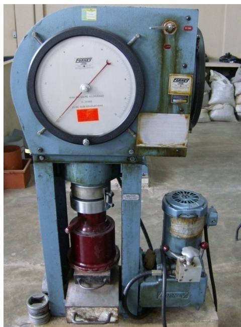
Figura 33 – Ensaio de resistência ao esmagamento.
