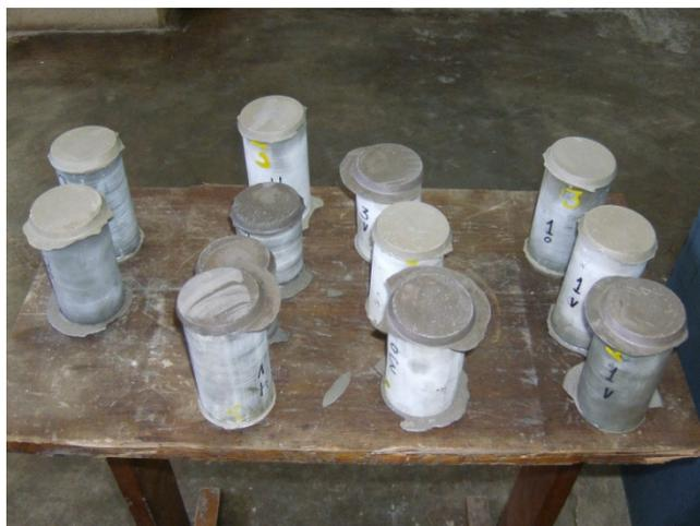
Figura 61 – Testemunhos de quartzitos submetidos ao ensaio de resistência a compressão.
