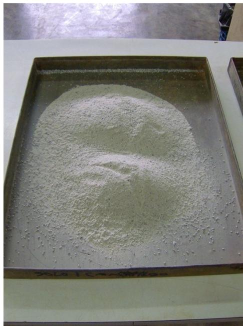
Figura 31 – Material passante na malha 1,7mm.
