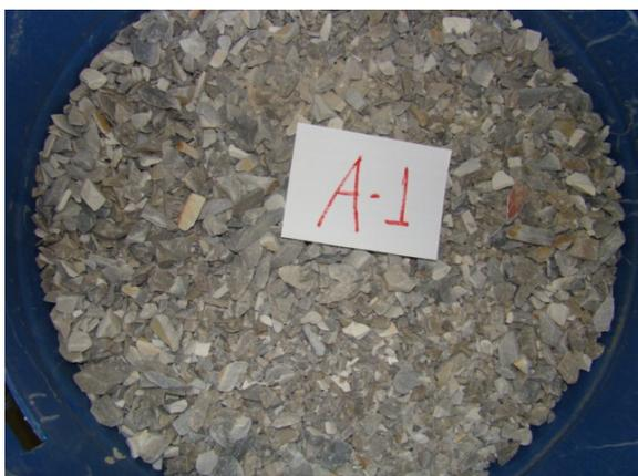
Figura 38 – Agregado graúdo de quartzito GLO2
