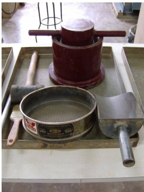
Figura 32 – Equipamentos utilizados para ensaio de resistência ao esmagamento.
