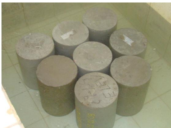
Figura 44 – Corpos-de-prova submetidos a cura saturada
