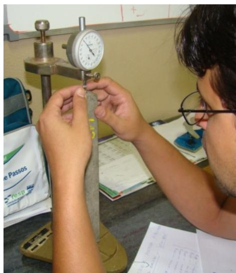
Figura 35 – Medidas de expansão das barras de argamassa.
