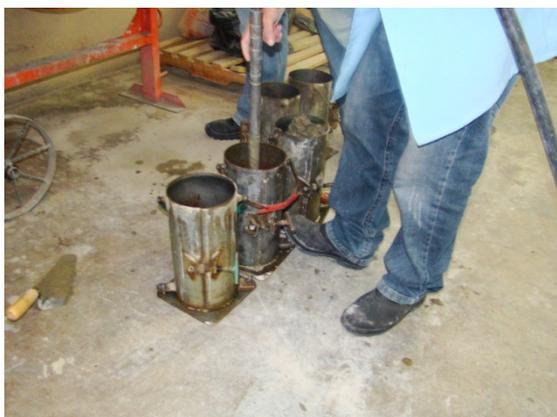
Figura 42 – Moldagem dos corpos-de-prova
