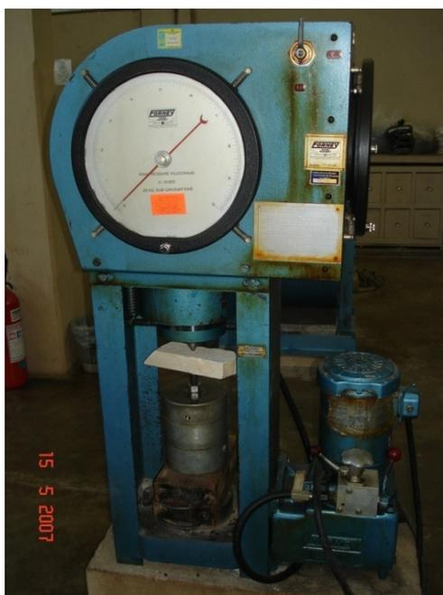
Figura 24 – Prensa hidráulica adaptada para ensaio de carga pontual.
