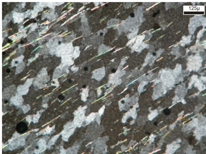
Fotomicrografia 13: Mesma imagem da fotomicrografia anterior, a Nicóis Cruzados, destacando a orientação dos cristais de mica (palhetas coloridas) e a orientação e assimetria dos grãos de quartzo.
