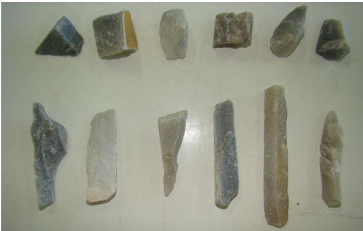
Figura 52 – Observações realizadas na forma dos grãos após processamento em Britador 2 (Tipo Mandíbula).
