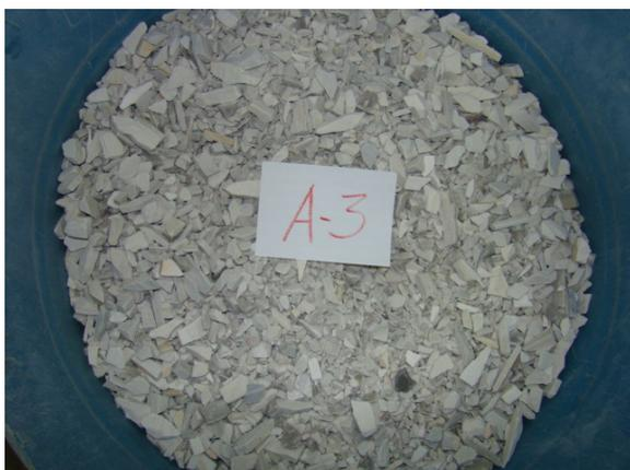
Figura 40 – Agregado graúdo de quartzito SJB2
