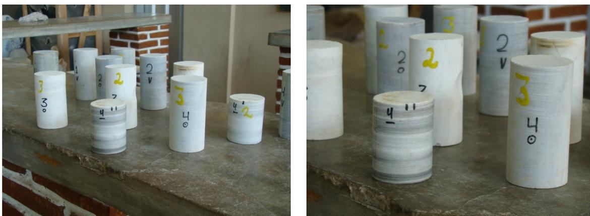
Figura 29 – Testemunhos de quartzitos extraídos para realização do ensaio de resistência à compressão.
