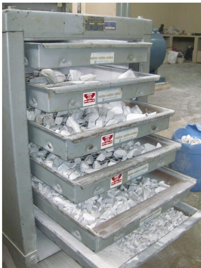
Figura 28 – Realização do ensaio de composição granulométrica.
