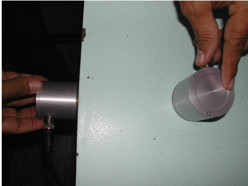
Figura 6.8 – Ensaio de ultra-sonografia.
