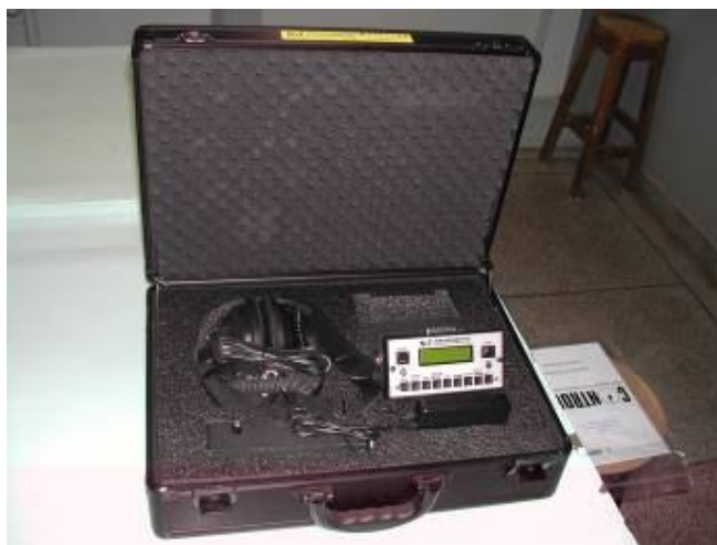
Figura 4.10 – Pacômetro – instrumento para se medir afastamento das armaduras.
