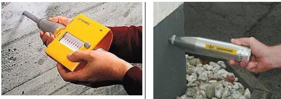
Figura 4.2 – Esclerômetro de reflexão tipo Schmidt.
