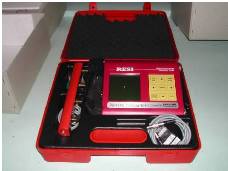
Figura 4.8 – Resi – equipamento para se medir a resistividade.
