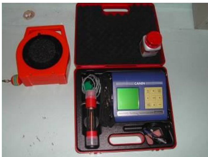
Figura 4.9 – Canin – instrumento para análise de corrosão.
