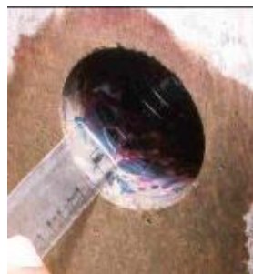
Figura 4.11 – Ensaio de carbonatação em extração de testemunho.
