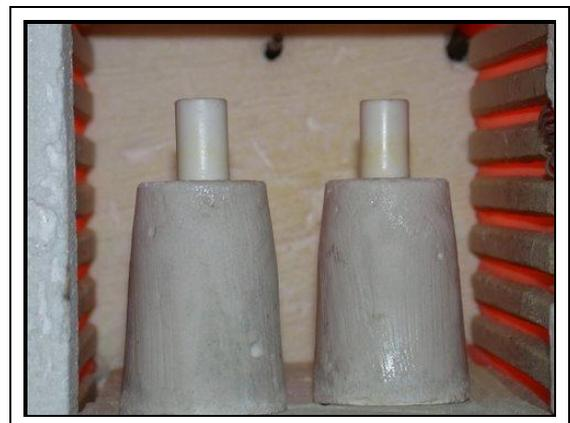
Figura 6 - Eliminação da cera em forno
