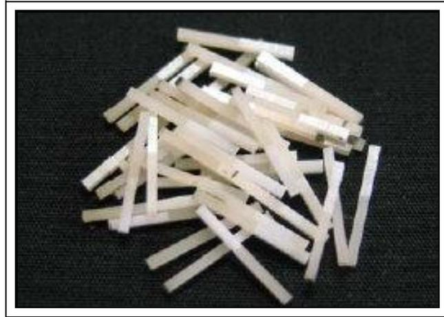
Figura 16 – Palitos obtidos na cortadeira metalográfica
