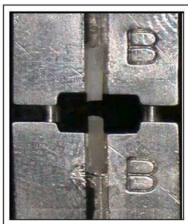
Figura 19 - Palito já fraturado visto no dispositivo de Geraldeli
