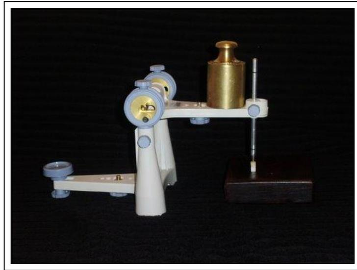
Figura 12 – Articulador semi ajustável adaptado para aplicação da carga
