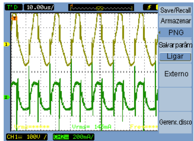
Figura 7.19 – Tensão e corrente na saída do conversor a 70 kHz.
