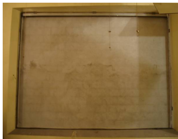
Figura 7.11: Parede rebocada posicionada para o teste de isolamento sonora.
