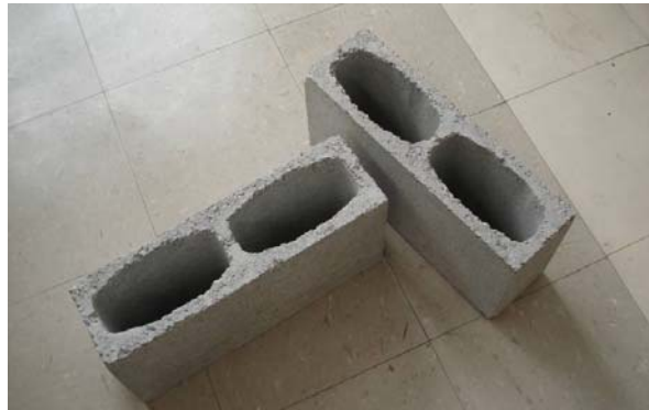
Figura 7.1: Amostras dos blocos utilizados na confecção da parede para teste de isolamento.
