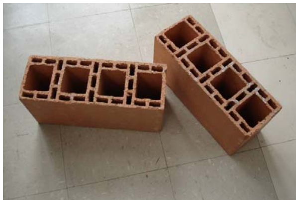
Figura 7.13: Amostras dos blocos utilizados na confecção da parede para o teste de isolamento sonora.
