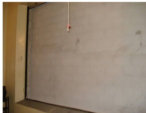
Figura 7.15: Parede na câmara reverberante, para o teste de isolamento sonora.
