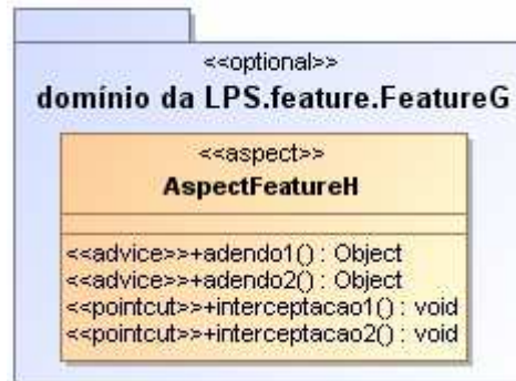
Figura 18 - Exemplo da modelagem de uma feature opcional com refinamento de Mudanças no Comportamento dos Métodos e Atributos.
