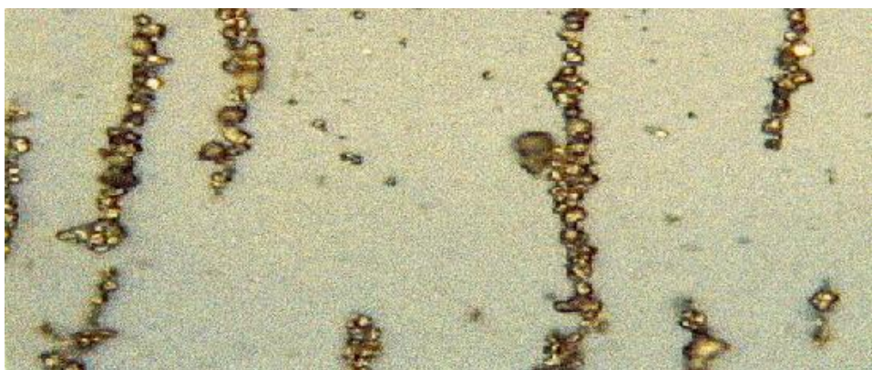
Figura 3.3. Microfotografia da liga a-Y_{0,37}Fe_{0,63} formada com tm=50 h (500x).
