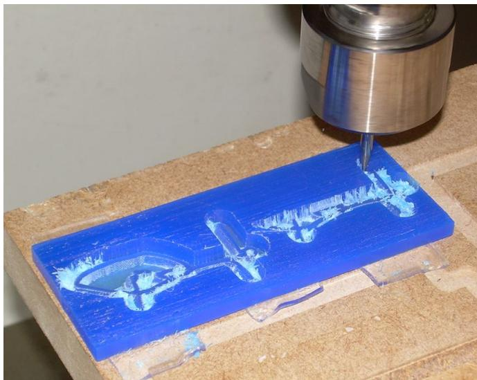
Figura 52: Usinagem automatizada dos modelos no bloco de cera.
