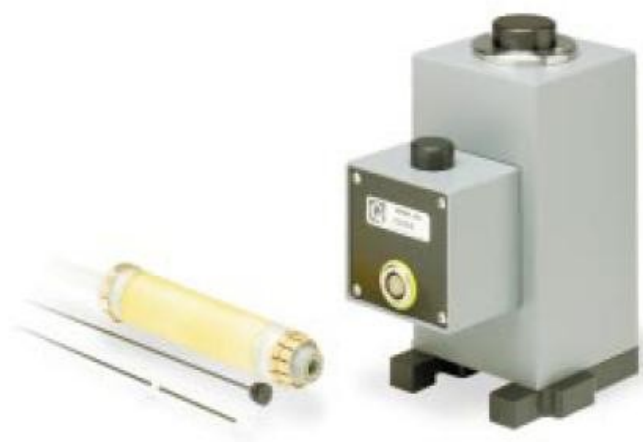
Figura 4.2-12: (a) Servo motor, haste do porta amostra e conjunto de bobinas do módulo ACMS [39] .
