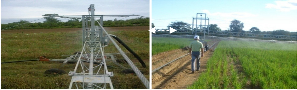
Anexo 3. Barras irrigadoras: componente do sistema autopropelido instalado na EEP-UFT, Gurupi – TO (2008).
