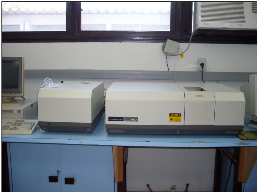
Figura 9: Espectrofotômetro Perkin Elmer, modelo 1760 x FT-IR
