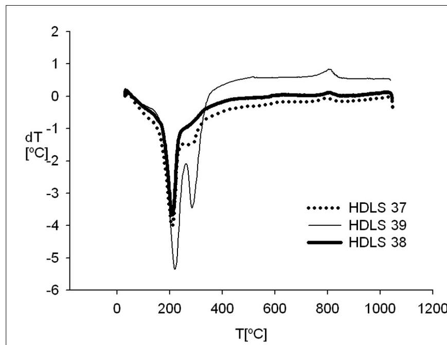
Figura 20: Termogramas (ATD) das amostras HDLS 37, 38 e 39
