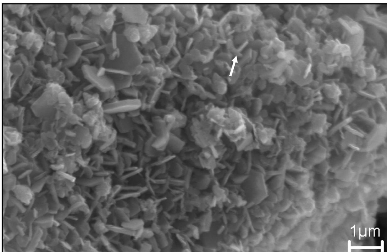
Figura 22: Micrografia da amostra HDLS 37. Notar a presença de cristais com faces definidas.
