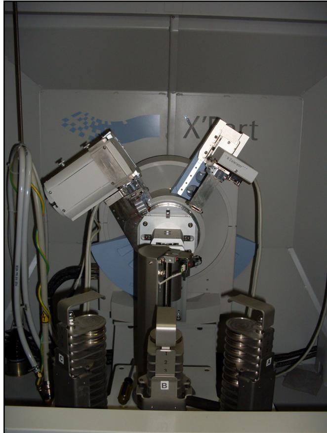
Figura 7: Difratorômetro de raios-X de marca PANalytical, modelo X'PERT PRO
