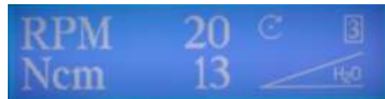
Figura 45: Configuração do motor para o aperto do transdutor.
