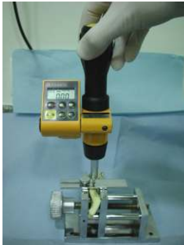
Figura 25: Simulação do modelo de realização do torque de remoção
