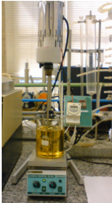
Figura 3. 4 – Produção do biodiesel em escala de laboratório: etapa de aquecimento do óleo de soja a 55°C sob agitação de 300 rpm
