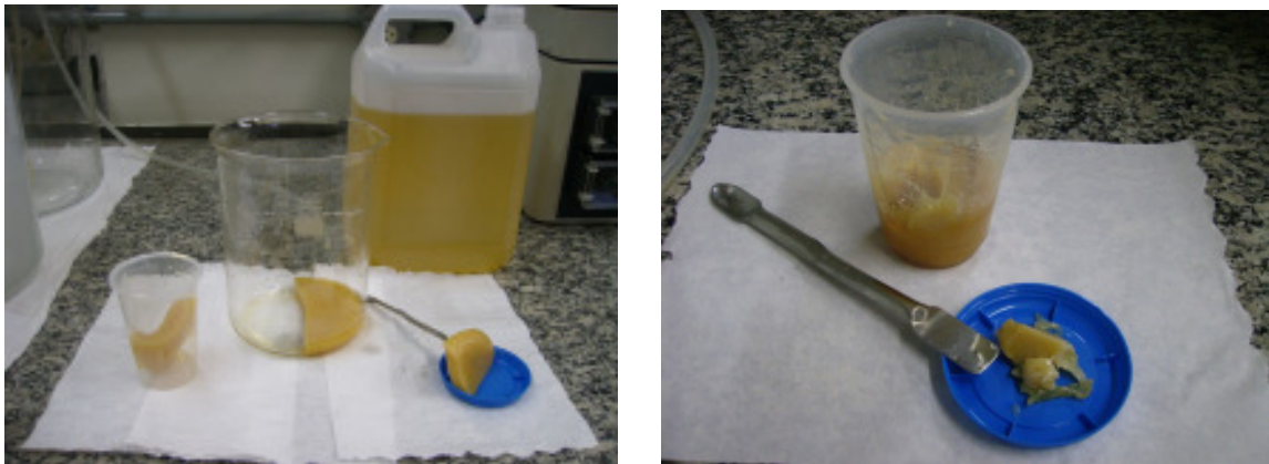
Figura 3. 8 – Produção do biodiesel em escala de laboratório: aspecto da glicerina utilizada como afluente a ser tratado após dissolução em água
