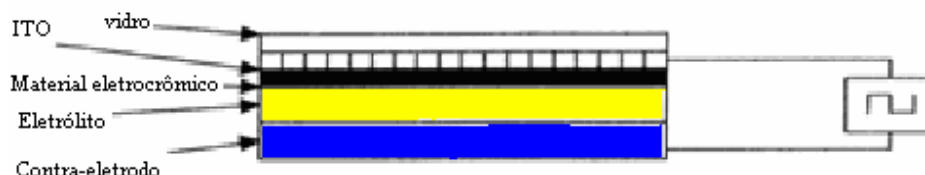
Figura 3.2 – Diagrama esquemático de um dispositivo electrocrômico [31].
