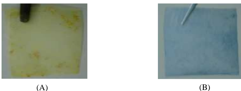
Figura 6.3 - (A) Membranas após imersão em solução de ferricianeto de potássio e (B) após exposição à solução de cloreto férrico.
