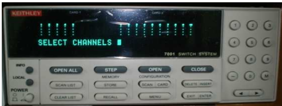
Figura 6.8 - chassi de controle 7001 com placa Hall 7065
