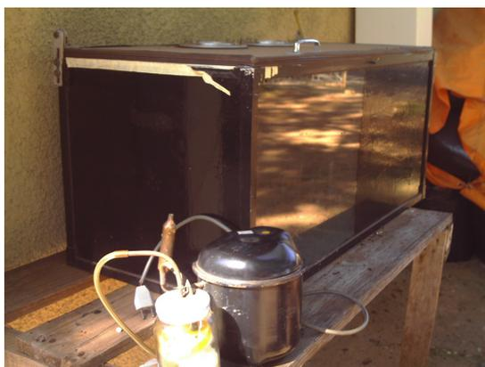
Fig. 05 – Vista externa da câmara de inalação utilizada para exposição dos animais à fumaça.
