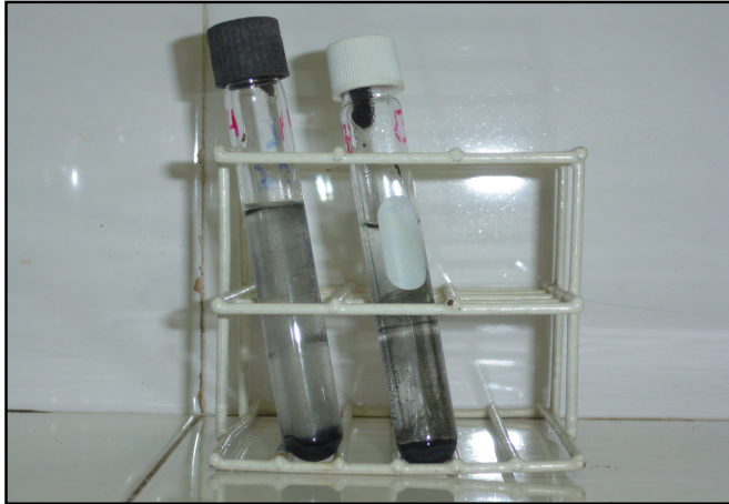
Figura 20 - Resultado em meio de cultura para o processo de sulfato redução, onde há precipitação sulfato de magnésio e sulfato ferroso, observa-se mudança na coloração do meio
