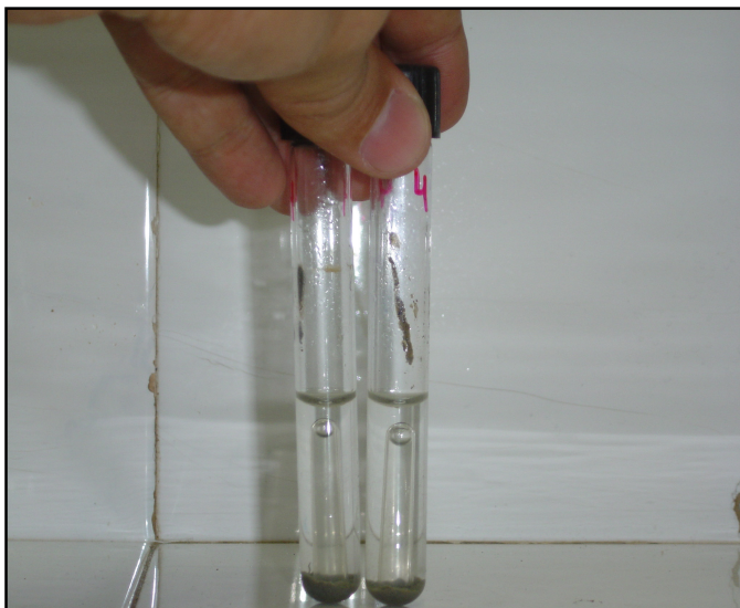
Figura 19 - Resultado em meio de cultura para o processo de desnitrificação e produção de N_2 , a atividade pode ser verificada pela presença de bolhas dentro do tudo de Durham.
