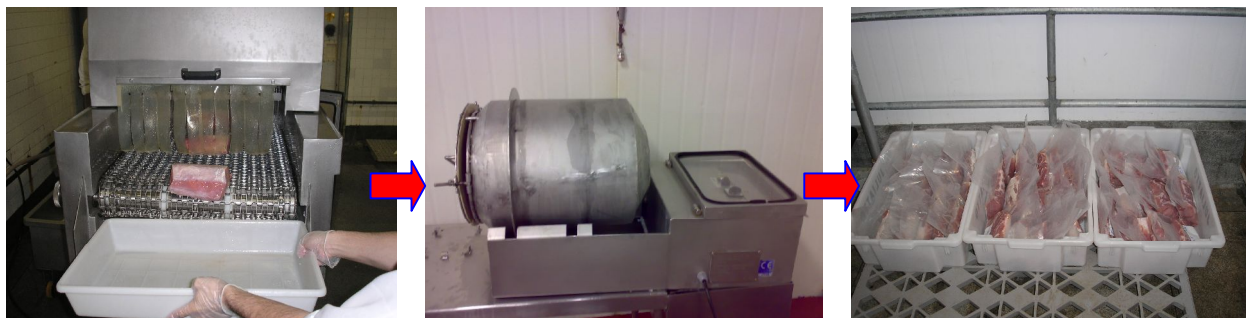
FIGURA 8 – ETAPAS DE INJEÇÃO DOS LOMBOS SUÍNOS COM SALMOURA, MASSAGEAMENTO EM TUMBLER E EQUALIZAÇÃO.
