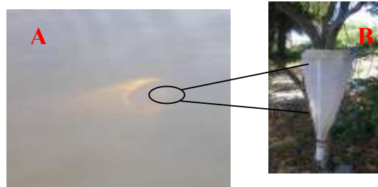
Figura 5.3 - (A) visualização da rede abaixo da coluna d'água; (B) rede de zooplâncton.
