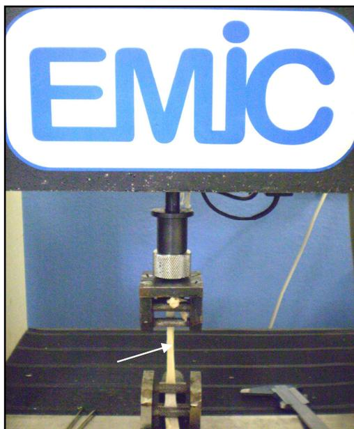
**FIGURA 3.** Imagem fotográfica da máquina universal de ensaio EMIC<sup>®3</sup> (modelo DL10000), na qual foram realizados o ensaio mecânico de tração nas amostras peritoniais (seta) de paca.
